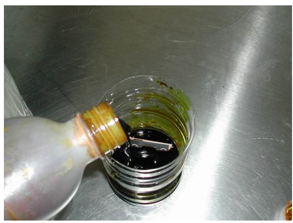
將小保持瓶放入含熱水的大保持瓶中,隔水加溫.(目的是要使蝕刻加速)
