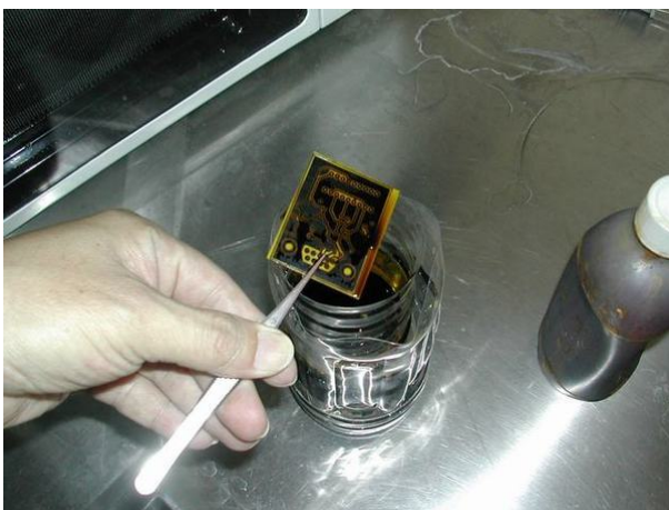
約 10 分鐘即完成蝕刻,可以從蝕刻處判斷,是否含有粉紅色的銅面即可知處理程度)
