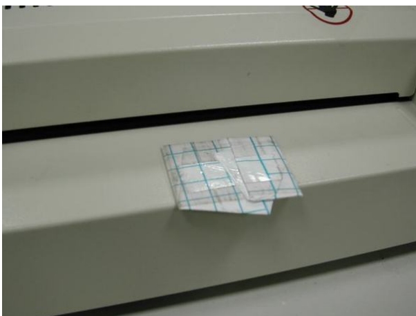
這是加熱後的情形,可以明顯看出其加熱壓實的表面.
