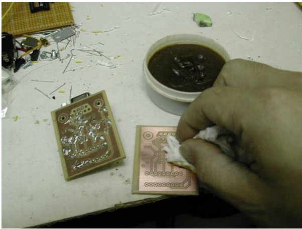
這次我有再加一處理,就是在銅面上,塗點助焊劑,不知可不可以防止它氧化,旁邊是我已完成之 RCD programmer,可以比較它們的氧化程度)
