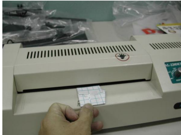
使用護貝機確實加熱(亦可用電燙斗加熱-150 度左右加熱各 20 趟)
